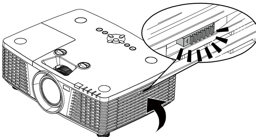
6. После замены воздушного фильтра включите проектор и выполните сброс таймера воздушного фильтра.
