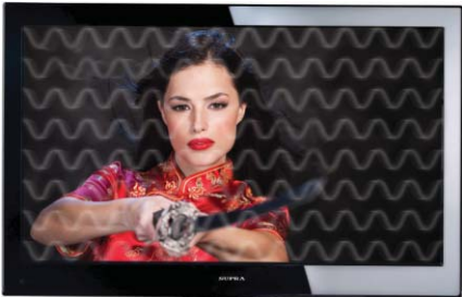
Изображение с кривыми линиями и дрожит. Обычно это вызвано электромагнитным излучением работающих вблизи приборов (фенов, мобильных телефонов, радиоприемников или радиопередатчиков).
