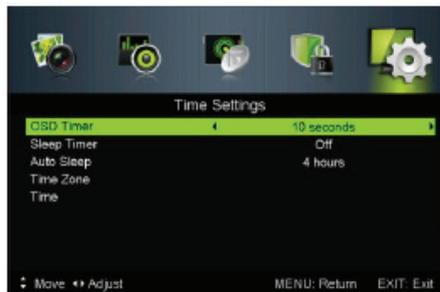
**OSD Timer** – Время отображения экранного меню. Установите время отображения экранного меню, по истечении которого при отсутствии операций оно будет исчезать с экрана: 10, 20, 30 или 60 секунд, - или отключите функцию.
