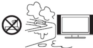
Не используйте телевизор вблизи воды, например, рядом с раковиной, мойкой или стиральной машиной, во влажном подвале, вблизи бассейна и т. д. После транспортировки в условиях низкой температуры перед включением телевизора дайте выдержку около часа при комнатной температуре, чтобы испарился конденсат. Не включайте телевизор сразу. Наличие влаги на компонентах телевизора может вызвать пожар, поражение электрическим током или другие негативные последствия.
