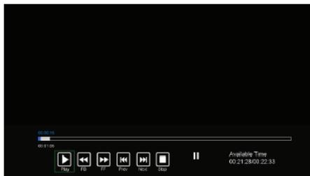
В режиме просмотра канала цифрового телевидения нажмите кнопку ►|| на пульте ДУ, чтобы включить функцию сдвига по времени. Просмотр передачи будет приостановлен, при этом телевизор будет осуществлять ее видеозапись. Когда вы захотите продолжить просмотр, нажмите кнопку ►|| еще раз.
