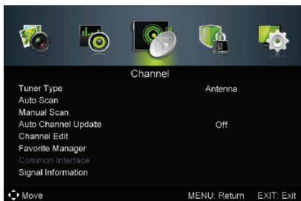
**Tuner Type** – Режим приема. Выберите Antenna (Антенна), Cable (Кабель) или Satellite (Спутник).
