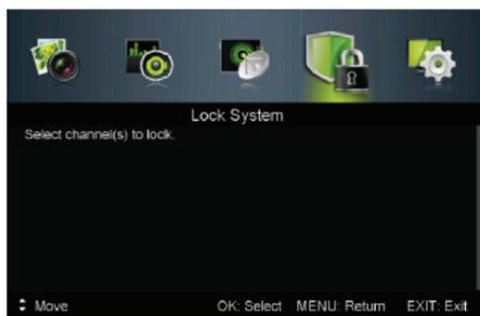
Кнопками **▲▼** выберите канал, который нужно заблокировать, и нажмите кнопку **OK**. Рядом с заблокированными каналами отображается значок блокировки. Данная функция доступна только в режиме ТВ.
