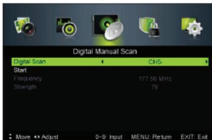
Digital Scan – Начало поиска. Установите номер телеканала, для которого нужно провести поиск.
