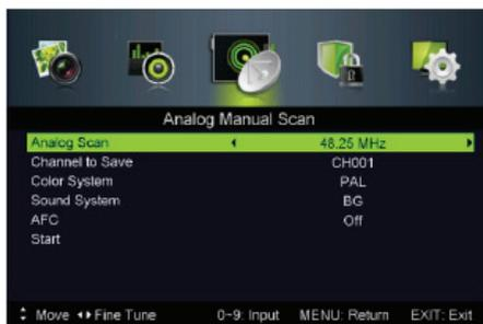
Analog Scan – Начало поиска. Установите частоту, с которой нужно начать поиск.
