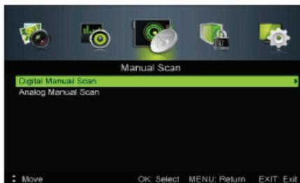
Digital Manual Scan – Поиск каналов цифрового телевидения вручную. Выделите данный параметр и нажмите кнопку ОК, чтобы перейти в дополнительное меню.
