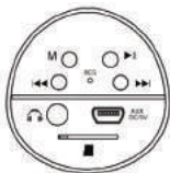
Порт для подключения кабеля Micro-USB (зарядка.линейный разъем AUX)
