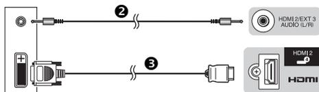
2 Стерефонический кабель с минигнездом Ø 3,5 мм
