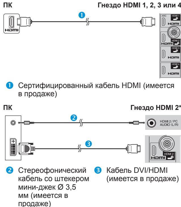
\* В случае использования гнезда HDMI 2 необходимо выбрать нужную опцию в меню «Выбор аудио» в зависимости от типа подключенного кабеля HDMI (Для получения подробной информации см. стр. 43).
