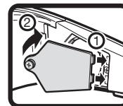
**6** Закрутите винт, удерживающий крышку батарейного отсека.
