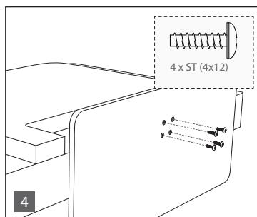
**Русский:** Чтобы собрать подставку к телевизору, Вам понадобится крестовая отвертка. Чтобы избежать повреждения экрана телевизора во время сборки убедитесь, что телевизор размещен на мягкой поверхности ЖК-экраном вниз. Площадь поверхности должна превышать площадь экрана телевизора
