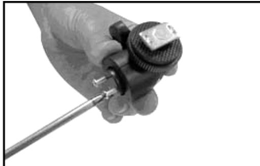
2. Закрепите шарнирное соединение:
