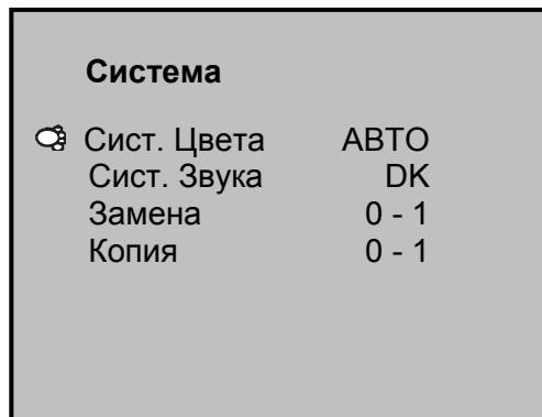
**Опция "Сист. Цвета"** предназначена для выбора системы кодирования цвета: АВТО, PAL, или SECAM. Рекомендуемое состояние данной опции - автоопределение системы ("АВТО"). Принудительная установка системы цветности может понадобиться, если сиг-
