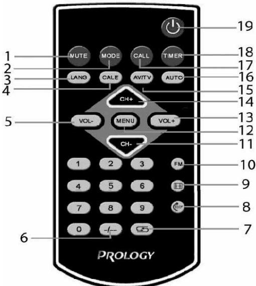
10. Кнопка **FM**. Кнопка включения/отключения FM-передатчика. Выберите частоту передачи сигнала 87.8МГц -108МГц (она не должна совпадать с частотой какой-либо радиостанции в указанном диапазоне) и нажмите на кнопку **FM** для начала передачи сигнала. Если частота будет совпадать с частотой какой-либо радиостанции, то функция не будет работать корректно. Например, если на 89 МГц есть радиостанция, то попробуйте сменить частоту, например на частоту 105.0 МГц.
