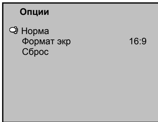
**Опция "НОРМА"** предназначена для разворота изображения по вертикали и может использоваться при установке телевизора под поверхность.
