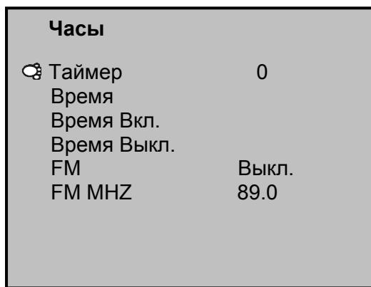
Опция "**Таймер**" предназначена для управления таймером автоматического отключения питания. На экране появится время в минутах до отключения питания: от 10 до 240 минут с интервалом в 10 минут или "0" (таймер отключен).
