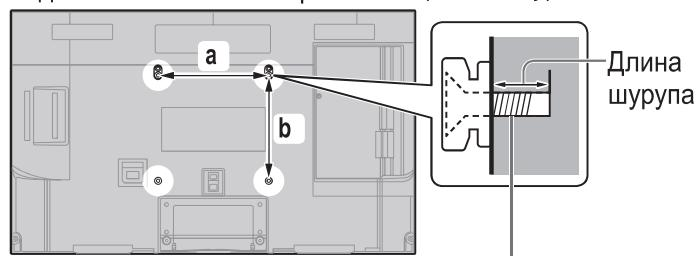
Шуруп для крепления телевизора на настенном
