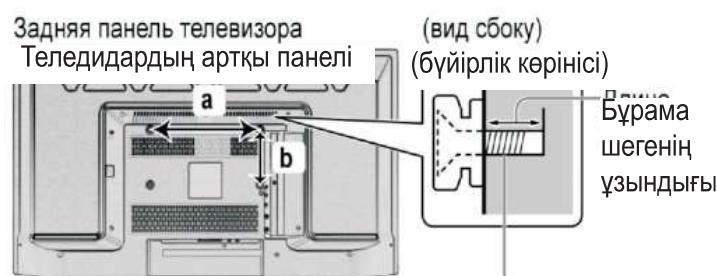
Шуруп для крепления телевизора на
