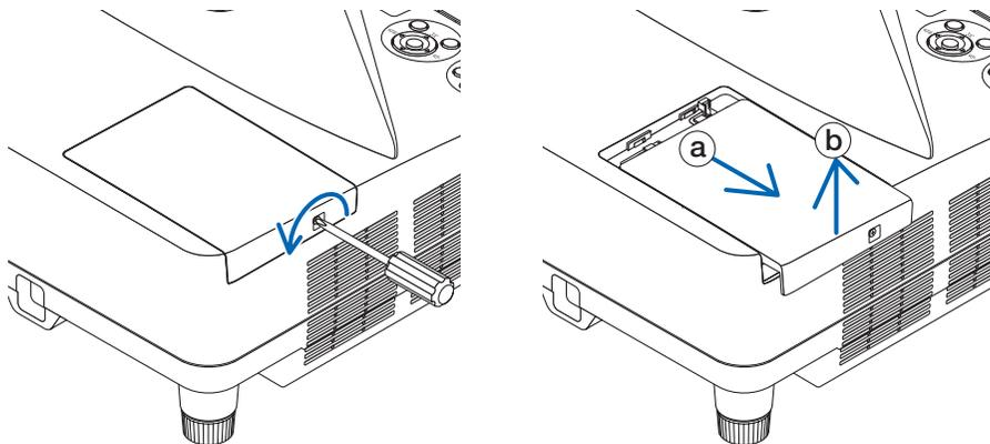
**2. Снимите корпус лампы.**
