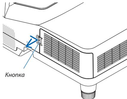
2. **Снимите два блока фильтра.**
