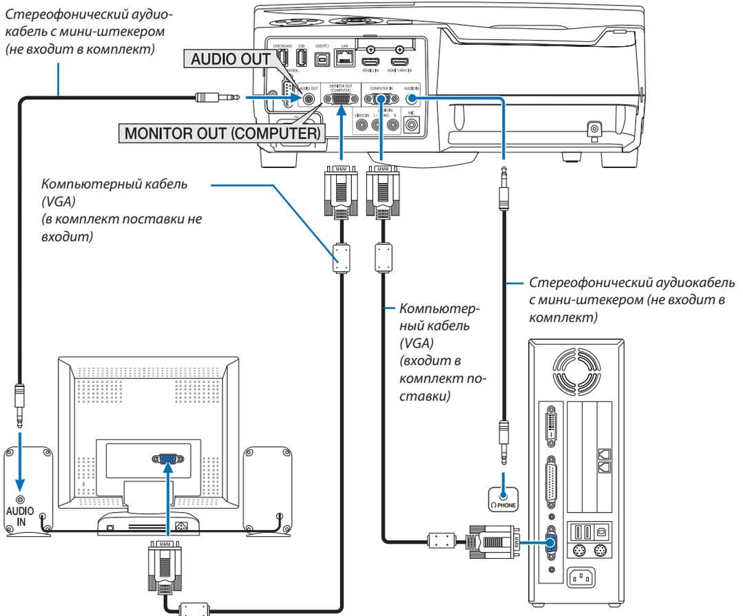
К проектору можно подключить отдельный внешний монитор для параллельного просмотра на мониторе проецируемого компьютерного аналогового изображения.
