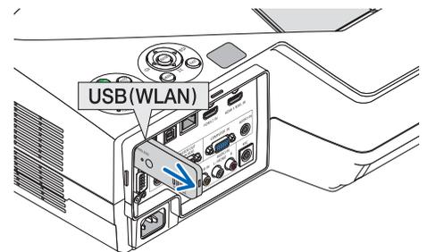
Пример подключения к беспроводной локальной сети
