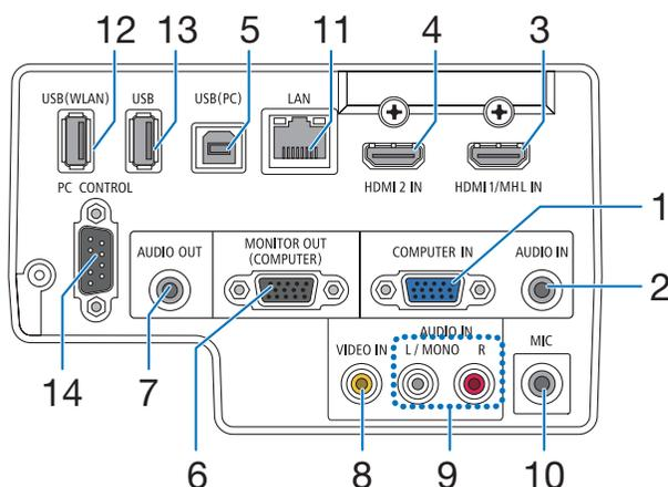
1. **COMPUTER IN/ Компонентный входной разъем (Mini D-Sub 15 Pin)** (→ стр. 106, 110, 113)
