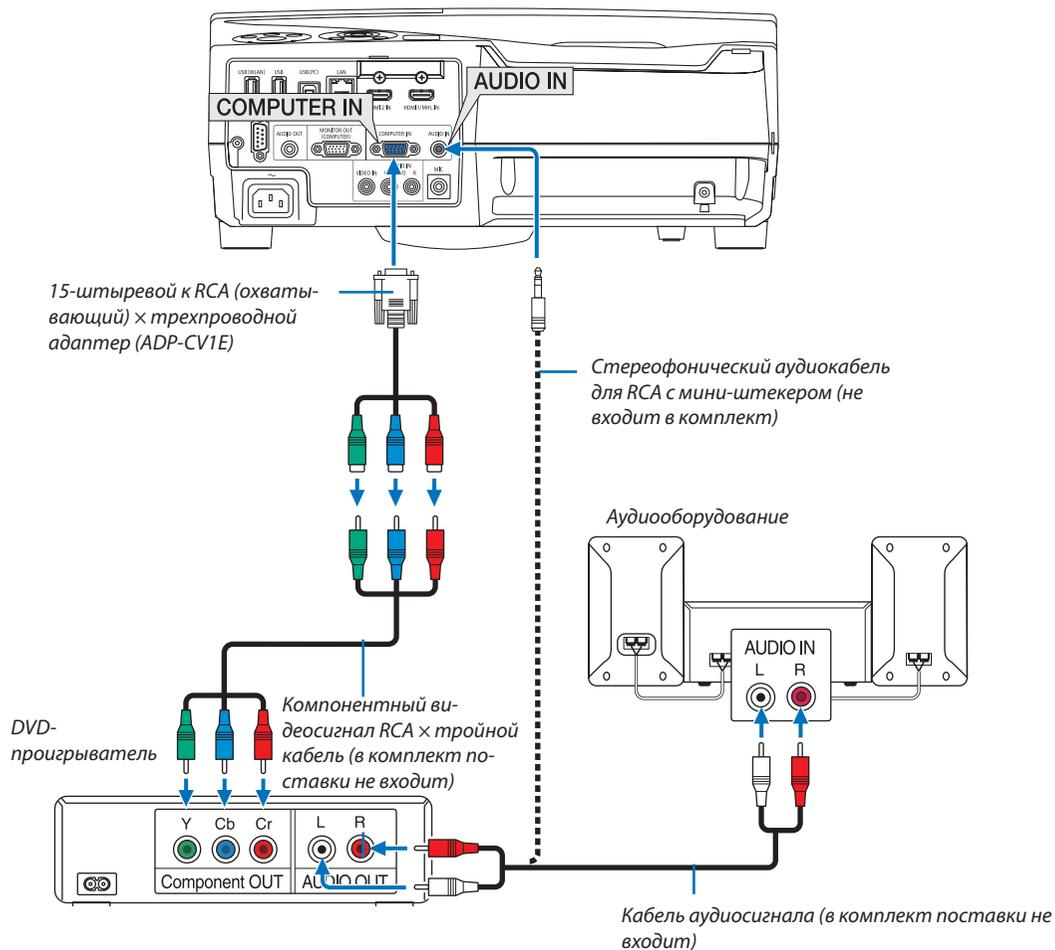
Компонентный сигнал будет отображен автоматически. Если этого не произошло, выберите меню [ВКЛ.] → [ОПЦИИ(1)] → [ВЫБОР СИГНАЛА] → [КОМПЬЮТЕР] и поставьте метку для селективной кнопки Компонент.
