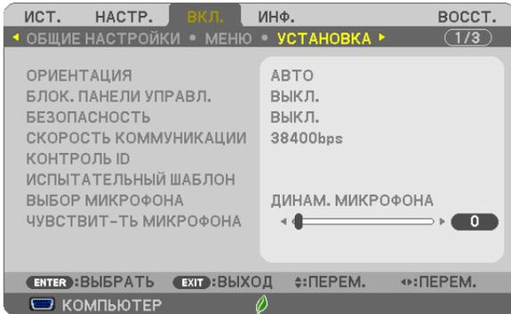
**Выбор ориентации проектора с помощью параметра [ОРИЕНТАЦИЯ]**
