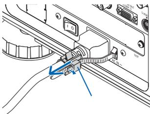
2. Растяните зажим силового кабеля так, чтобы извлечь силовую кабель.
