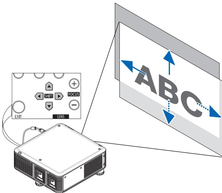
2. С помощью кнопок **LENS SHIFT ▼▲◀▶** передвиньте проецируемое изображение.
