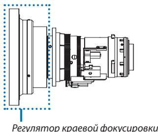
Если объектив был снят с проектора, а затем снова установлен на проектор, то после этого восстановите значения настроек, сохраненные в памяти объектива, а затем выполните действия согласно шагу 2 процедуры, описанной выше, чтобы повторно настроить фокусировку по краям проецируемого изображения.
