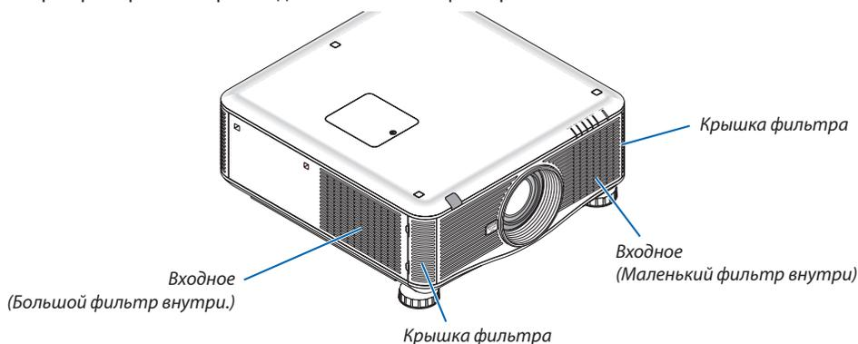
**1. Нажмите в двух местах (как показано на рисунке), чтобы отсоединить и снять крышку фильтра.**
