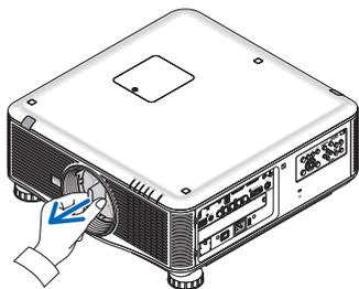
Чтобы прикрепить пылезащитную крышку к проектору, найдите выступ на нижнем крае пылезащитной крышки и вставьте его в отверстие на проекторе так, чтобы треугольная метка (▽) была направлена вниз (① на рисунке ниже), а затем, придерживая ручку, нажмите на верхний край пылезащитной крышки по направлению к проектору, чтобы выступы попали в гнездо (② на рисунке ниже).
