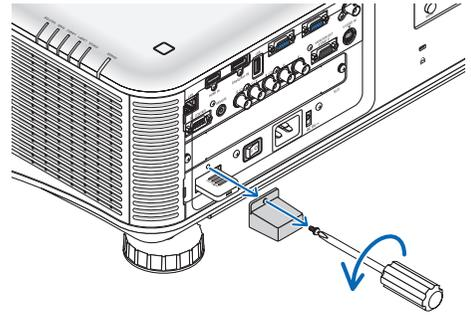
3. Извлеките USB-модуль беспроводной локальной связи из USB (LAN) порта.
