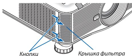
**2. Снимите два фильтра, вытянув их.**
