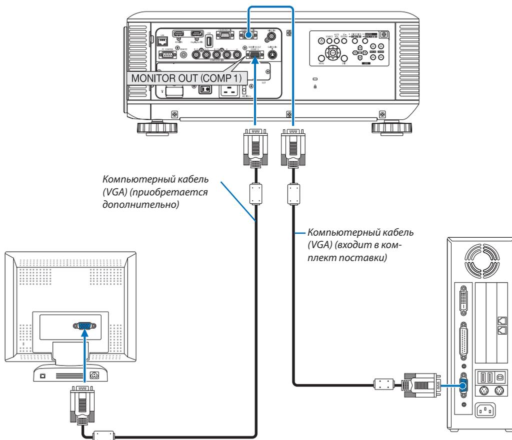
К проектору можно подключить отдельный внешний монитор для параллельного просмотра на мониторе компьютерного аналога проецируемого изображения.
