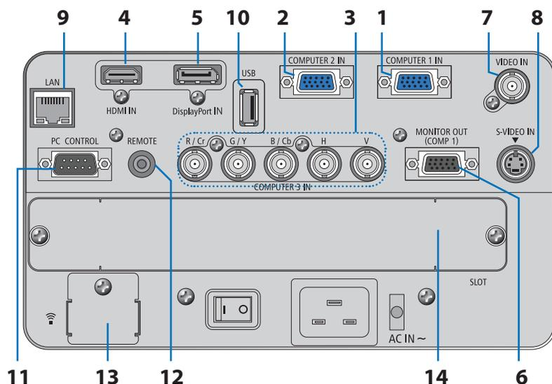
1. COMPUTER 1 IN/ Компонентный входной разъем (Mini D-Sub 15 Pin) (→ стр. 14, 164, 169)
