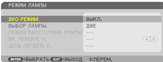
Данная система двух ламп обеспечивает увеличение срока службы лампы, повышенную яркость и наличие запасной лампы (лампы с продлённым сроком службы).
