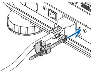
2. Закрепите силовой кабель с помощью фиксатора силового кабеля.
