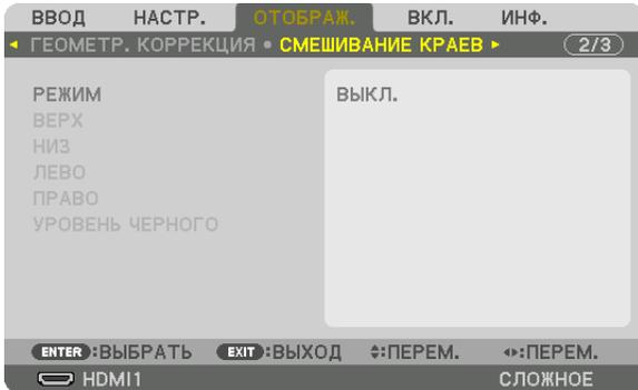
Регулирует края (границы) проекционного экрана при проецировании изображения с высоким разрешением, используя комбинацию из нескольких проекторов в верхнем, нижнем, левом и правом положениях.
