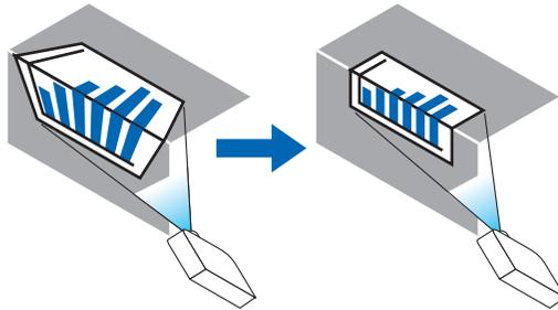
\* Также возможна коррекция при проекции с обратного угла.
