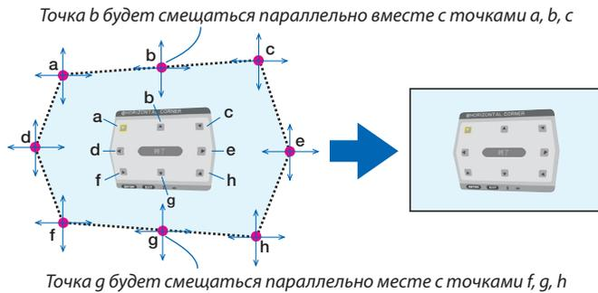
[Точки регулировки на экране [VERTICAL CORNER] и точки перемещения проекционного экрана]
