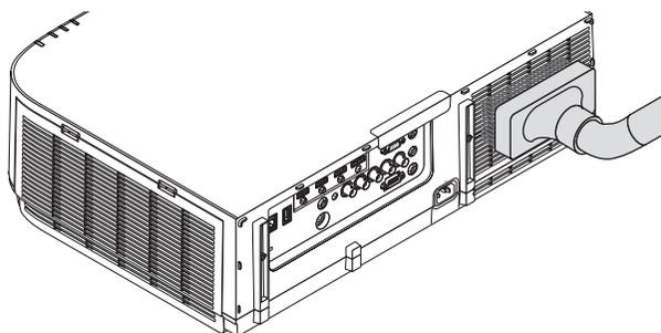
*Удалите пыль с вентиляционных отверстий с помощью пылесоса.*
