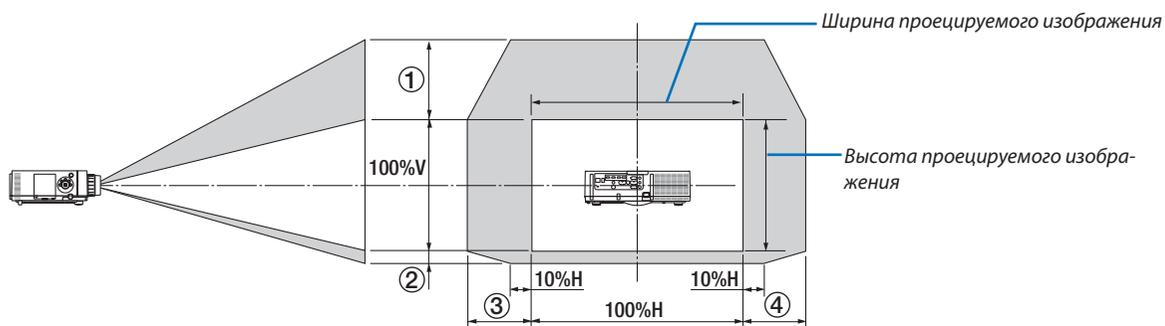
Условные обозначения: V обозначает длину по вертикали (высоту проецируемого изображения), H обозначает длину по горизонтали (ширину проецируемого изображения).
