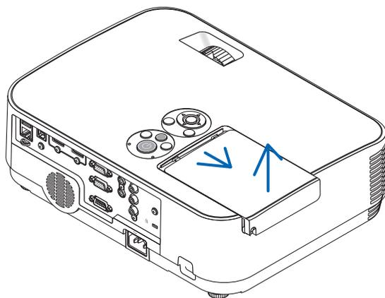
**2. Снимите корпус лампы.**
