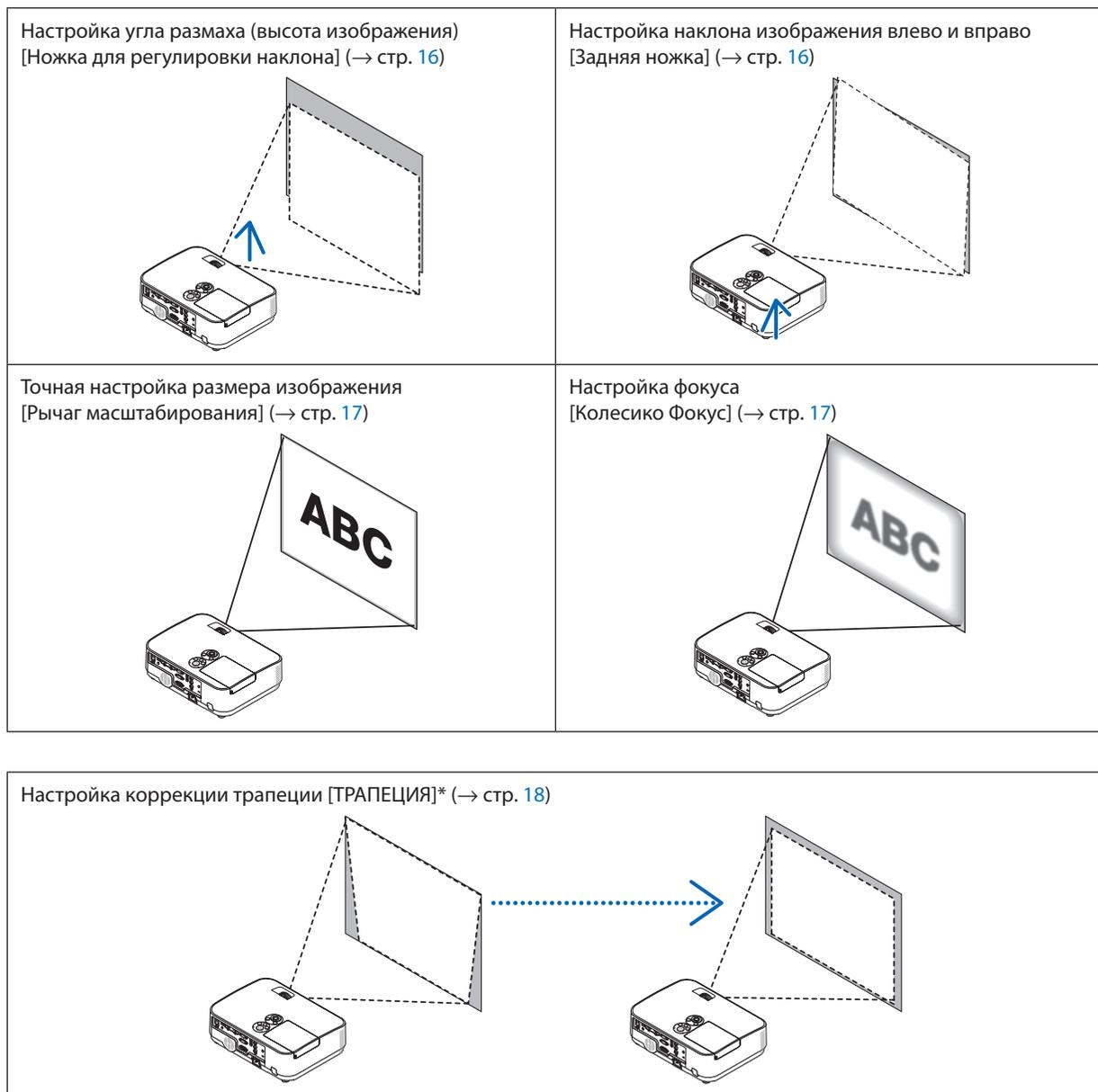
Функция автоматической коррекции трапеции включена на момент поставки.
