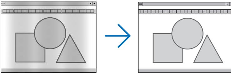
**ЧАСЫ** ..... Используйте данный параметр для точной настройки компьютерного изображения или удаления каких-либо вертикальных полос, которые могут появиться на изображении. С помощью этой функции можно настроить тактовые частоты, которые приводят к появлению на изображении горизонтальных полос.
