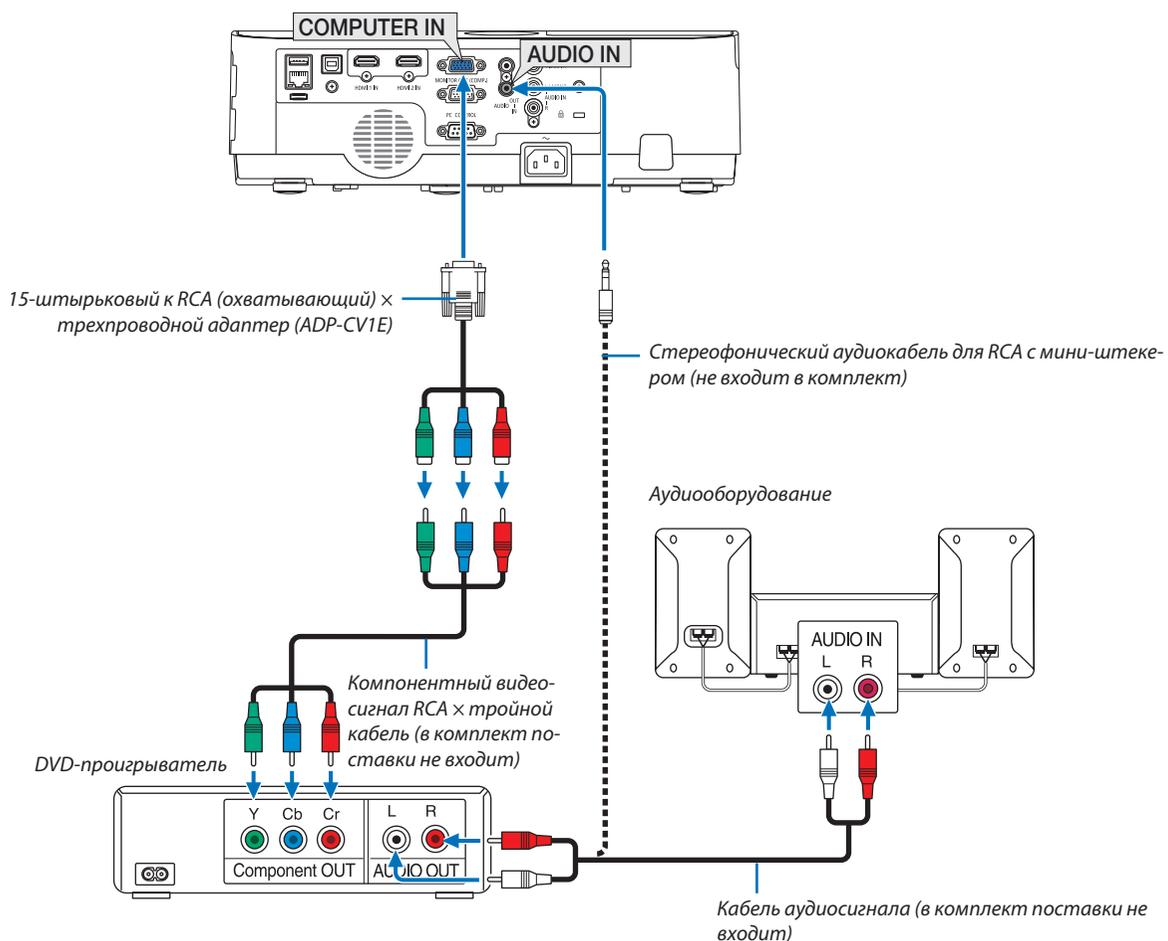
Компонентный сигнал будет отображен автоматически. Если этого не произошло, выберите меню [ВКЛ.] → [ОПЦИИ(1)] → [ВЫБОР СИГНАЛА] → [КОМПЬЮТЕР] и поставьте метку для селекторной кнопки Компонент.
