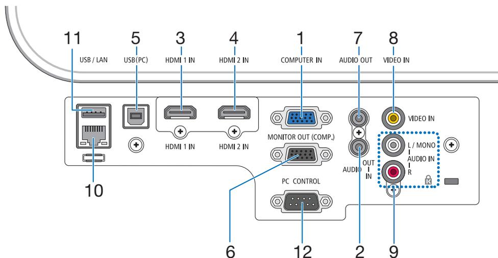
1. **COMPUTER IN/Компонентный входной разъем (Mini D-Sub 15 Pin)**
