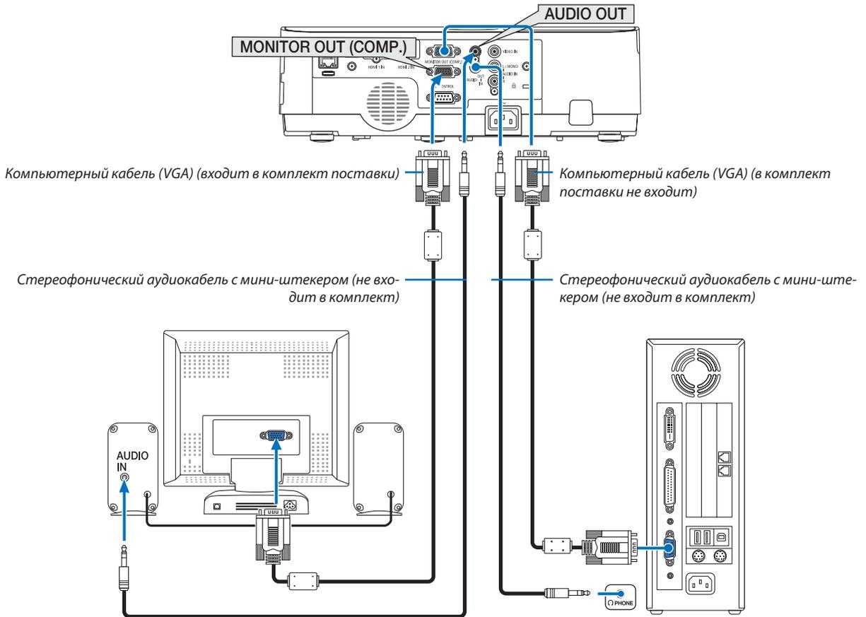
К проектору можно подключить отдельный внешний монитор для параллельного просмотра на мониторе проецируемого компьютерного аналогового изображения.
