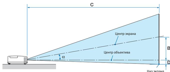
B = вертикальное расстояние между центром объектива и центром экрана
