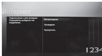
При осуществлении доступа посредством технологии WiFi выберите «Беспроводное», при подключении к сети посредством Ethernet кабеля (стр.11 поз.11) выберите «Проводное». Произведите необходимые настройки согласно настройкам Вашего роутера и информации от интернет провайдера. Данный этап можно пропустить и вернуться к нему позднее, зайдя в раздел настройки в режиме Smart TV.
