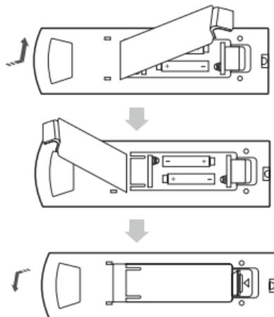
1. Откройте крышку отсека для элементов питания.
