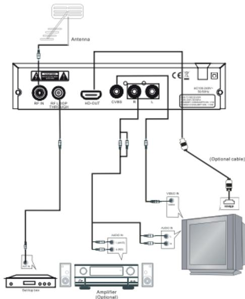
Подключите к проигрывателю телевизор в соответствии со схемой выше.
