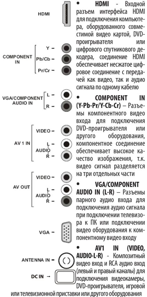
• **HDMI** - Входной разъем интерфейса HDMI для подключения компьютера, оборудованного совместимой видео картой, DVD-проигрывателя или цифрового спутникового декодера, соединение HDMI обеспечивает несжатое цифровое соединение с передачей как видео, так и аудио сигнала по одному кабелю
