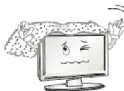
Не закрывайте вентиляционные отверстия. Установливайте телевизор в соответствии с инструкциями изготовителя. Вентиляционные и другие отверстия
