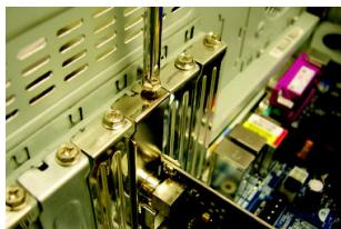
1-2 以螺絲將電視卡固定在電腦機殼上，再將電腦外殼蓋回。
