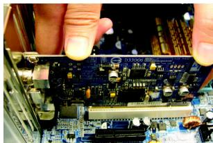
1-1 從防靜電袋中將電視卡拿出來，再將電視卡小心且確實地插入 PCI 插槽中。
