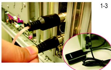
1-3 將 FM 廣播天線、數位電視天線、立體聲音源線<sup>(註一)</sup>等的接頭依序連接至電視卡，遙控器的 USB 接收盒<sup>(註二)</sup>則連接至電腦的 USB 接頭。
