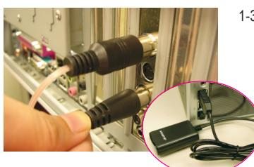
1-3 Подключите к разъемам платы ТВ-тюнера antennу FM-диапазона, antennу цифрового ТВ и стереофонический аудиокабель<sup>(Замеч.1)</sup>. Подключите приемник сигналов<sup>(Замеч.2)</sup> пульта дистанционного управления к разъему USB компьютера.
