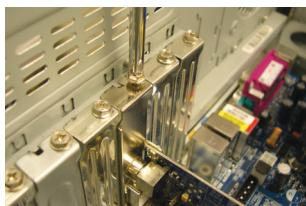
1-2 Прикрепите плату ТВ-тюнера к корпусу компьютера с помощью винтов и закройте корпус компьютера.
