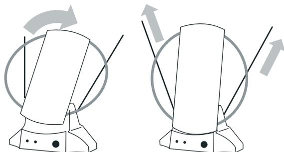
Местоположение антенны является одним из главных условий качества принимаемого сигнала. Не помещайте антенну на металлическую поверхность, так как она может стать препятствием для приема сигнала.
