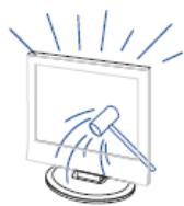
Основа жидкокристаллической панели, используемой в телевизоре, сделана из стекла. Поэтому она может разбиться при падении телевизора или ударе его другим предметом.
