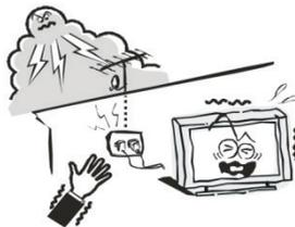
Для дополнительной защиты данного телевизора при грозовой погоде или когда не планируется его использование в течение длительного времени, отключите телевизор от розетки питания и отсоедините антенный кабель. Это предотвратит повреждение телевизора от молнии или из-за перепадов напряжения.
