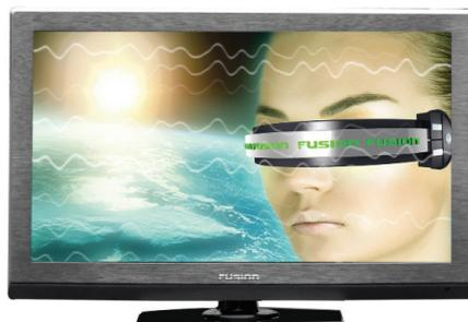
**Изображение с кривыми линиями и дрожит.** Обычно это вызвано электромагнитным излучением работающих вблизи приборов (фенов, мобильных телефонов, радиоприемников или радиопередатчиков).
