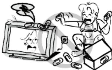
Никогда не вставляйте посторонние предметы в вентиляционные отверстия и открытые части телевизора. При эксплуатации телевизора используется высокое напряжение. Попадание посторонних предметов внутрь телевизора может послужить причиной поражения электрическим током и привести к повреждению деталей телевизора. Детям младше 3 лет не следует пользоваться телевизором.
