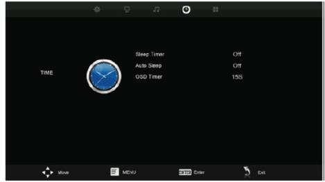
Sleep Timer – Таймер спящего режима. Установите время, через которое телевизор должен автоматически перейти в режим ожидания, или отключите данную функцию.
