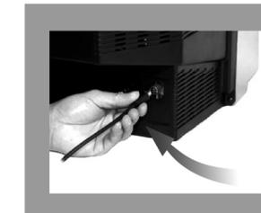
Подключить коаксиальный кабель к гнезду входа РЧ (RF).
