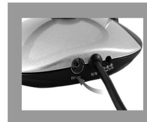
Подключить адаптер питания переменного тока к гнезду с задней стороны антенны и вставить адаптер питания в стандартную сетевую розетку.
