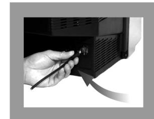
Подключить коаксиальный кабель к гнезду входа РЧ (RF).
