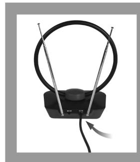
Подключить адаптер питания переменного тока к гнезду с задней стороны антенны и вставить адаптер питания в стандартную сетевую розетку.
