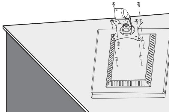
Утопленный монтаж. Установите между лицевой панелью и монитором 4 установочные шайбы. Вкрутите в монитор 4 винта через монтажные отверстия в лицевой панели и установочных шайбах.
