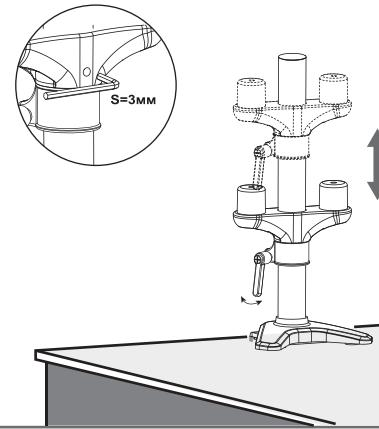
Поместите установочное кольцо на требуемой высоте, а затем прикрутите с большим усилием таким образом, чтобы кронштейн удерживался на месте. Расположите алюминиевую опорную деталь над установочным кольцом и зафиксируйте ее с помощью торцевого ключа.
