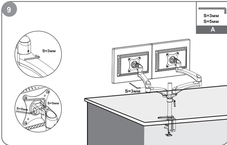
Используйте торцевой гаечный ключ для регулировки крепления шарнирного зажима. Для ослабления крепления поверните против часовой стрелки, для затяжки – по часовой стрелке.
