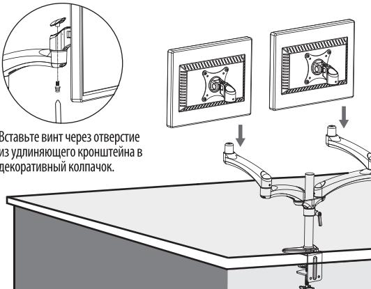
Вставьте винт через отверстие из удлиняющего кронштейна в декоративный колпачок.
