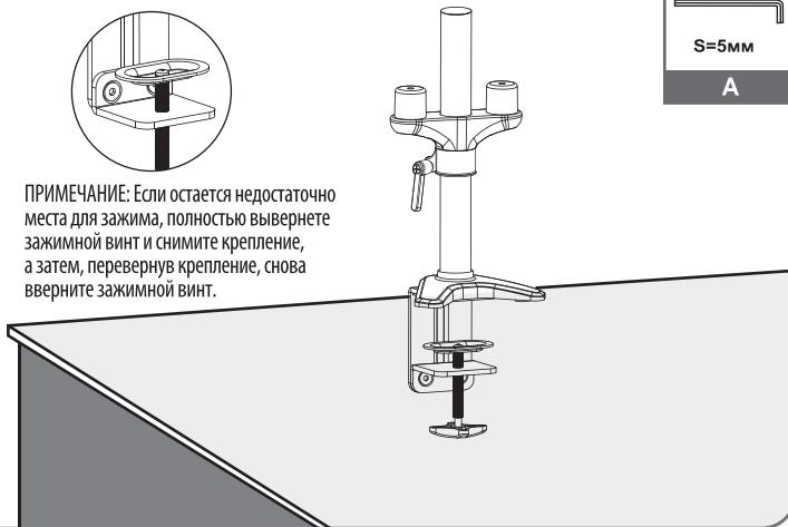
Затяните зажим с помощью зажимного винта таким образом, чтобы кронштейн был надежно закреплен на столе.
