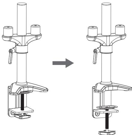
Ослабьте затяжку зажимного винта таким образом, чтобы обеспечить достаточное место для монтажа на крае стола.
