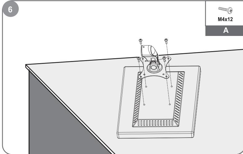
Установка заподлицо: Вкрутите 4 винта в лицевую панель монитора через монтажные отверстия.
