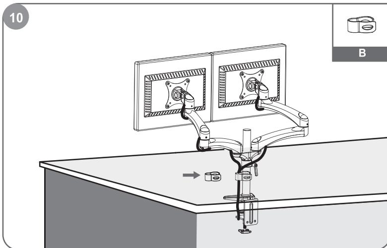
Установите кабели в кабельные каналы. Обеспечьте достаточное провисание кабелей в местах сгиба для последующей регулировки.
