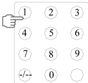
Нажмите любую из цифровых кнопок, расположенных на пульте дистанционно-го управления, при этом телевизор перейдет в режим приема той телевизион-ной программы, номер которой соответствует номеру нажатой кнопки.
