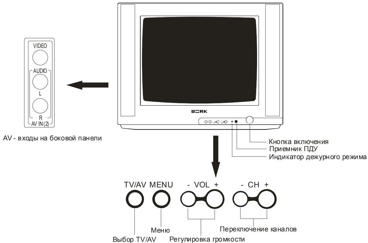
**Кнопка включения:** Нажмите на кнопку для включения телевизора. При этом индикатор светится. Для выключения телевизора нажмите кнопку еще раз.
