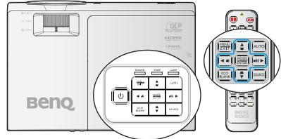
Кнопками **▼** / **▲** на проекторе или пульте ДУ откройте страницу «Трапец. искаж. 2D». Кнопками **▲** / **▼** отрегулируйте положение по вертикали в диапазоне от -30 до 30. Кнопками **◀** / **▶** отрегулируйте положение по горизонтали в диапазоне от -30 до 30.
