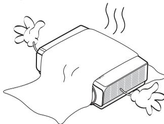
Затруднение вентиляции проектора через отверстия может привести к его перегреву и возгоранию.
