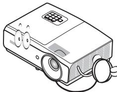
5. В некоторых странах напряжение в сети **НЕСТАБИЛЬНО**. Проектор рассчитан на безотказную эксплуатацию при напряжении сети питания перемен. тока от 100 до 240 В, однако сбои питания и скачки напряжения свыше  $\pm 10$  В могут привести к выходу проектора из строя. **Поэтому при опасности сбоев питания или скачков напряжения рекомендуется подключать проектор через стабилизатор напряжения, фильтр для защиты от перенапряжения или источник бесперебойного питания (UPS).**
