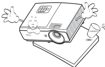
11. Не пытайтесь самостоятельно разбирать проектор. Детали внутри корпуса находятся под высоким напряжением, контакт с ними может привести к смертельному исходу. Единственным элементом, обслуживание которого может осуществляться пользователем, является лампа, имеющая отдельную съемную крышку. Ни при каких обстоятельствах не следует отвинчивать или снимать никакие другие крышки. Для выполнения обслуживания обращайтесь только к квалифицированным специалистам.
