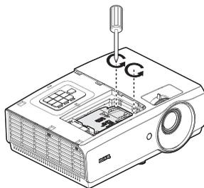
6. Поднимите ручку в вертикальное положение. С помощью ручки медленно вытяните лампу из проектора.
