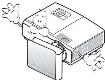
7. В процессе работы лампа проектора сильно нагревается. Перед заменой лампы необходимо дать проектору остыть в течение приблизительно 45 минут.
