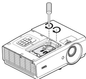
10. Подключите разъем лампы и поместите его на место, прежде чем установить крышку отсека лампы.
