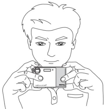
5. Нажмите на спуск наполовину, чтобы установить автоматический фокус. После установки цвет рамки фокуса изменится с белого (отсутствие фокусировки) на желто-зеленый (фокусировка).
