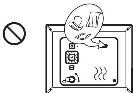
Чтобы гарантировать надежную работу прибора и защитить его от перегрева, не блокируйте вентиляционные отверстия.
