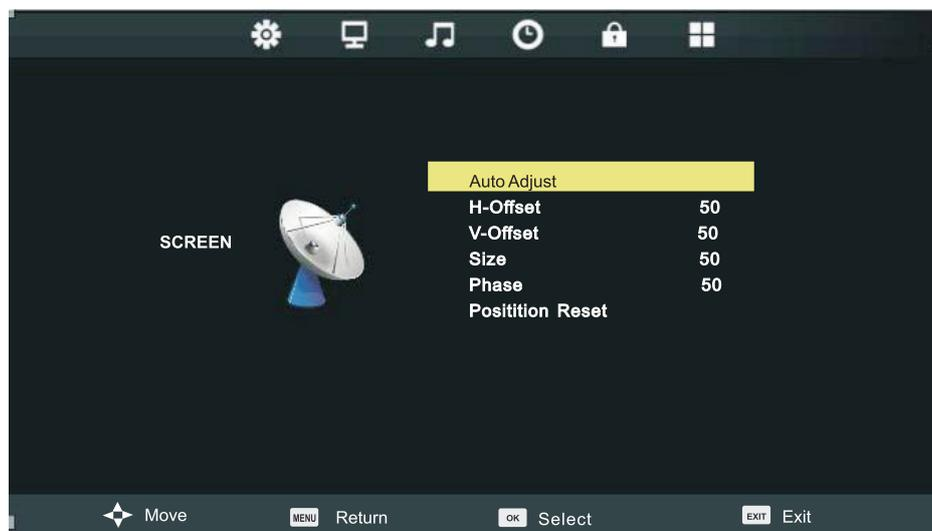
Меню Screen (Экран) доступно только в режимах VGA или DVI. В режиме использования входного DVI-сигнала, регулировке доступны только положение горизонтали и положение по вертикали.
