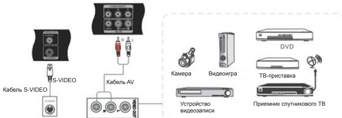
1. Соедините кабелем S-VIDEO порты на дисплее и периферийном устройстве.
