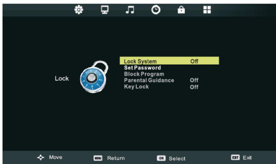
В меню блокировки можно изменить параметры блокирования дисплея. Для доступа к меню Lock (Блокировка) вначале нажмите кнопку MENU для отображения главного меню, а затем нажмите кнопки ◀/▶ для выбора меню Lock (Блокировка). Нажмите кнопку **ENTER** или ▶ для входа в меню Lock (Блокировка).
