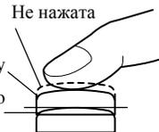
Когда кнопка затвора слегка нажата вниз, происходит окончание одного из этапов ее «полного» пути вниз. В этом полунажатом состоянии камера автоматически устанавливает значение фокуса и экспозиции. Как только происходит полное нажатие кнопки затвора вниз, происходит спуск затвора и последующая запись кадра.
