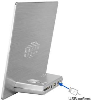
Подключите USB-кабель сначала в USB-порт компьютера, а затем в USB-разъем фотопамяти. Включите питание фотопамяти. На дисплее появится надпись “**Соединение установлено...**”, фотопамять подключена к ПК.
