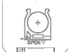
Отсек легко отсоединится от корпуса пульта ДУ. Установите в отсек новую батарею типа CR2025 так, чтобы сторона с маркировкой "+" (плюс) была сверху.
