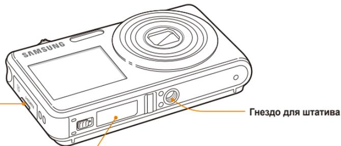
Крышка отсека для аккумулятора
