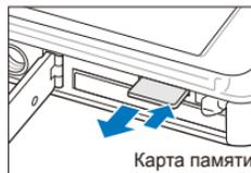
Слегка нажмите на карту памяти, чтобы освободить ее фиксатор, а затем извлеките ее из разъема.
