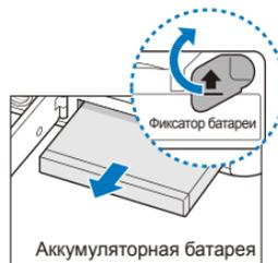
Отведите фиксатор вверх, чтобы извлечь батарею.
