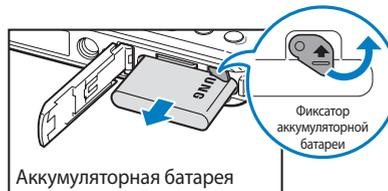
Сдвиньте фиксатор вверх, чтобы извлечь аккумуляторную батарею.
