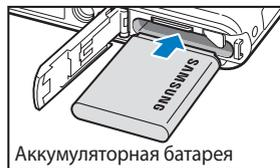
Вставьте аккумуляторную батарею эмблемой Samsung вверх.
