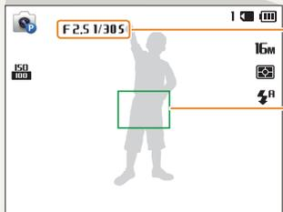
Камера автоматически установит диафрагму и выдержку.
