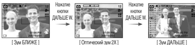
Цифровой зум ДАЛЬШЕ : когда включен цифровой зум, при нажатии кнопки W масштаб съемки будет уменьшаться пошагово. При освобождении кнопки зума W цифровое зуммирование прекращается. При нажатии на кнопку W сначала будет уменьшаться кратность цифрового, а затем оптического зума. Изменение масштаба прекратится при достижении минимального значения или при освобождении кнопки.
