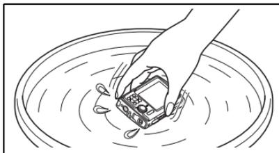
Выполните шаги с 1 по 4, затем проверьте, плавно ли перемещается крышка объектива. В случае нарушения плавного перемещения крышки объектива, промойте переднюю поверхность объектива под сильной струей водопроводной воды, при этом несколько раз нажав кнопку **POWER**.
