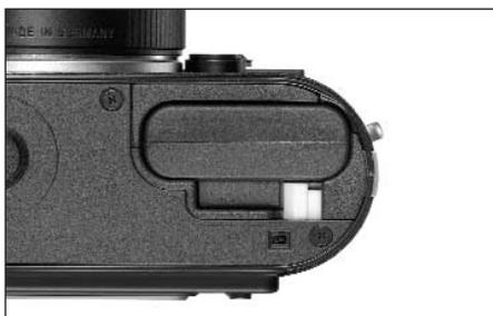
3. Поместите аккумулятор в отделение для аккумулятора контактами вперед. В отделении для аккумулятора (1.38) прижмите его так, чтобы подпружиненный белый фиксатор аккумулятора (1.39) защелкнулся над аккумулятором и зафиксировал его.
