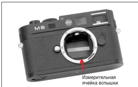
Фотоаппарат LEICA M8 определяет необходимую мощность фотовспышки путём включения одной или нескольких измерительных фотовспышек на доли секунды перед фотосъёмкой. Сразу после этого во время начала экспозиции будет включена основная фотовспышка.
