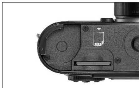
3. Вставьте карту памяти в гнездо (1.40) контактами назад и скошенным углом вниз. Двигайте её вовнутрь, не смотря на сопротивление пружины, до тех пор, пока не почувствуете, что карта зафиксировалась.
