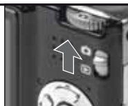
Установите аккумулятор Вдвиньте до щелчка
