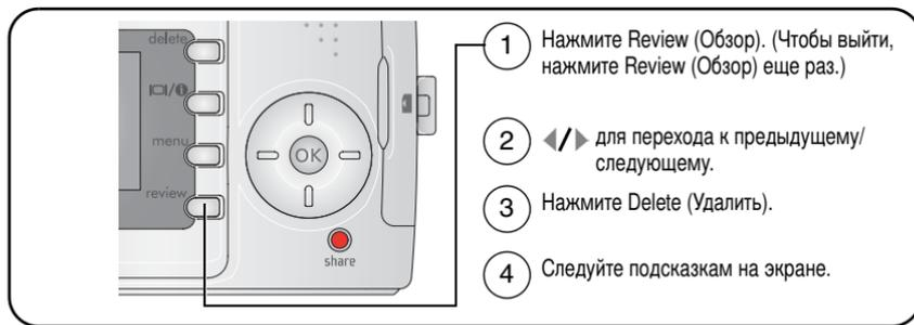
**PICTURE or VIDEO (СНИМОК или ВИДЕОКЛИП)** — удаление отображаемого снимка или видеоклипа.
