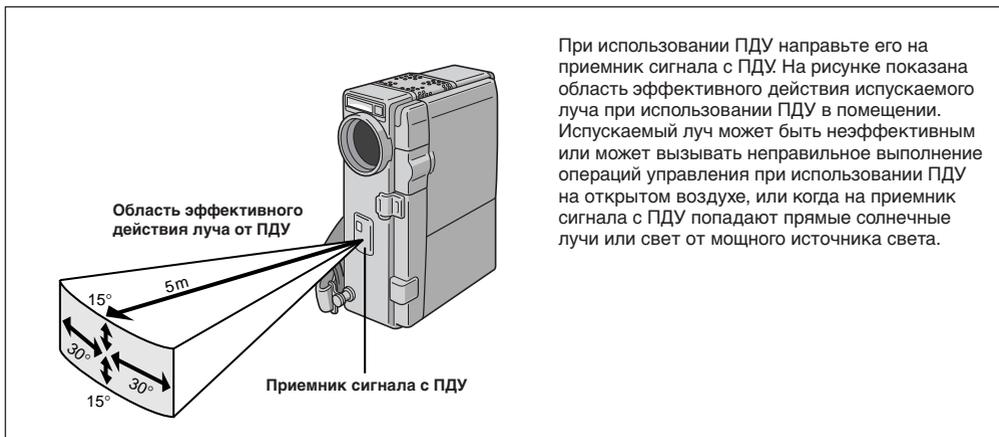
При использовании ПДУ направьте его на приемник сигнала с ПДУ. На рисунке показана область эффективного действия испускаемого луча при использовании ПДУ в помещении. Испускаемый луч может быть неэффективным или может вызывать неправильное выполнение операций управления при использовании ПДУ на открытом воздухе, или когда на приемник сигнала с ПДУ попадают прямые солнечные лучи или свет от мощного источника света.
