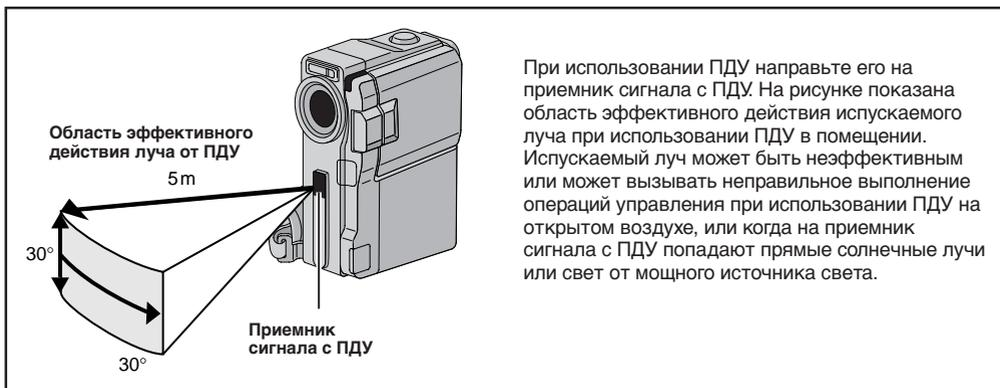
При использовании ПДУ направьте его на приемник сигнала с ПДУ. На рисунке показана область эффективного действия испускаемого луча при использовании ПДУ в помещении. Испускаемый луч может быть неэффективным или может вызывать неправильное выполнение операций управления при использовании ПДУ на открытом воздухе, или когда на приемник сигнала с ПДУ попадают прямые солнечные лучи или свет от мощного источника света.
