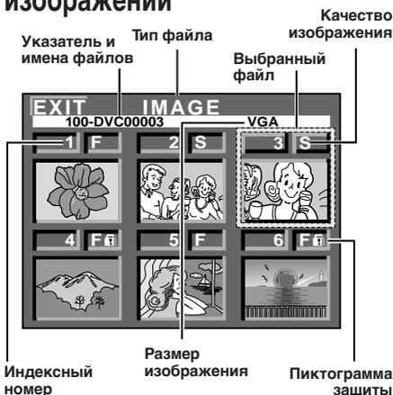
Возможно высвечивание хранящихся файлов вместе с их индексной информацией. Удобный для проверки файлов, сохраненных ранее, индексный экран также показывает качество изображения, режим размера изображения, указатель и имена файлов, а также какие файлы защищены от случайного стирания. Для высвечивания индексного экрана, ⇨ стр. 30.
