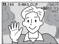
При повторном нажатии кнопки включения/выключения записи съемка прекращается.
