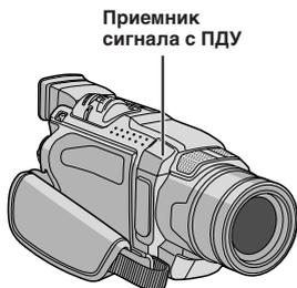
При использовании ПДУ направьте его на приемник сигнала с ПДУ. Примерная дистанция, на которой эффективен испускаемый луч при съемке в помещении - 5 метров.
