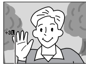
Индикатор фиксации ирисовой диафрагмы
