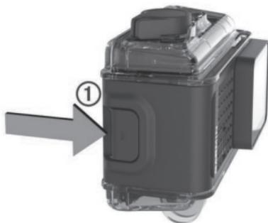
2 Удерживая защелку в нажатом положении, откройте переднюю часть фиксатора ②.
