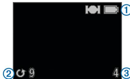
Устройство будет вести съемку через заданный интервал времени. На видоискателе отображается уровень сигнала GPS, уровень заряда аккумулятора ①, время до следующего снимка в секундах ② и количество сделанных снимков ③.
