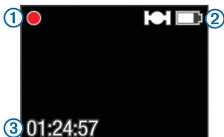
Видоискатель отобразит состояние записи ①, GPS и состояние заряда аккумулятора ②, а также оставшееся время записи ③.
