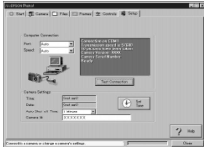
Меню Setup (Наладка) позволяет изменять установки связи с компьютером, а также другие установки параметров камеры, как, например, дата и время.
