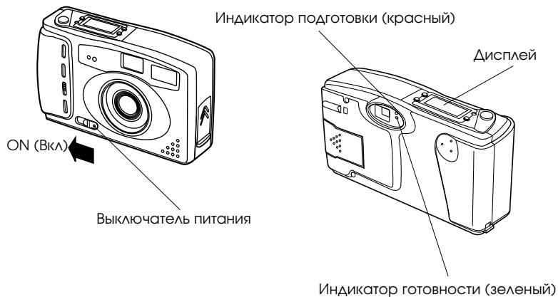
Переведите ползунок выключателя питания в положение OFF (Выкл), чтобы выключить камеру. Крышка объектива закрывается и гаснет дисплей.
