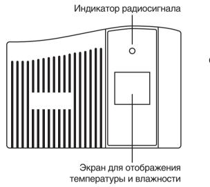
Переключатель отображения температуры в градусах Цельсия или Фаренгейта Отверстие для крепления на стене Подставка Кнопка перегрузки 2 батареи AAA (Reset) Водонепроницаемая прокладка
